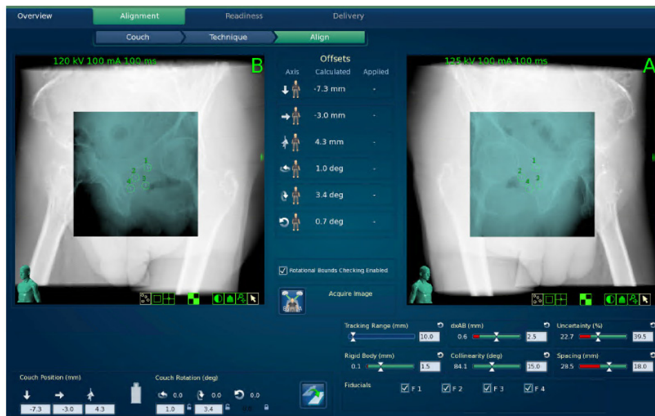
Rycina 9. Wyznaczenie przesunięć między obrazami DRR a Live X-ray metodą Fiducial Tracking [materiał własny]
