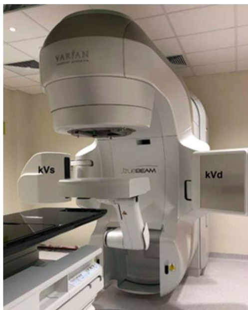
Rys. 4. System obrazowania (OBI) w akceleratorze TrueBeam firmy Varian: kVd – detektor promieniowania kilowoltowego, kVs – źródło promieniowania kilowoltowego (lampa rentgenowska); [źródło własne].
