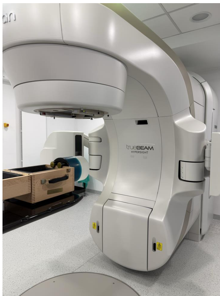
Rycina 1. Ustawienie fantomu Catphan 604 na akceleratorze TrueBeam podczas obrazowania CBCT.
